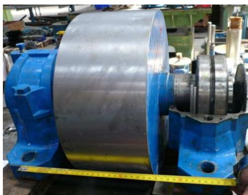
**Fabrication d'un galet porteur pour four tournant**
