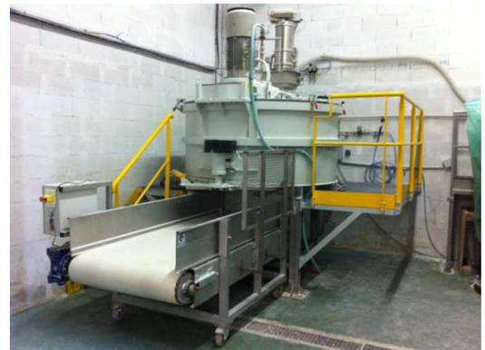
**Ensemble bande transporteuse inox et passerelle pour malaxeur**
