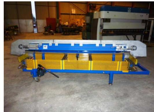
**Bande transporteuse double sens montée sur axe de rotation**
